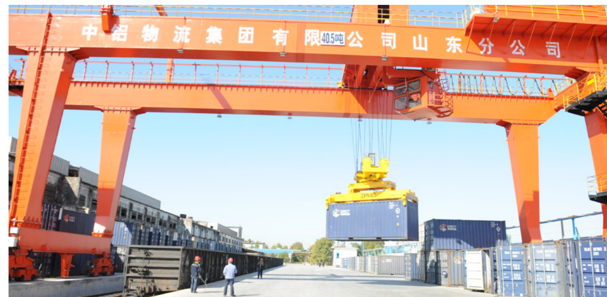
山东物流集装箱吊入火车
