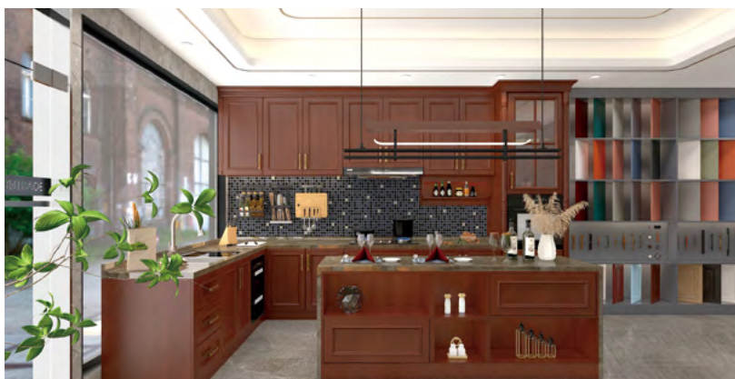
全铝家居以铝合金型材、铝合金蜂窝板为板材，表面经过喷涂、木纹、包覆等工艺处理，产品具有环保零甲醛、美观、防水、防火、抗菌、可回收等特点
