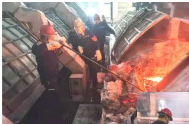
针对电解槽波动问题,近期,电解厂电解一车间组织党员骨干对130台电解槽进行了系统排查。技术人员重点就电解槽摇架变形、槽体撕裂等异常情况进行了排查,通过安排专人加强重点区域监控,保证异常点受控,确保电解槽平稳运行。图为技术人员正在查看槽况。
